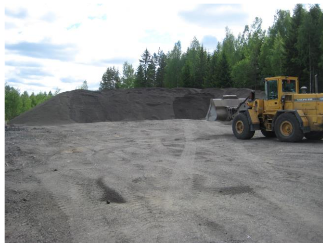
Återvunnen krossad asfalt
